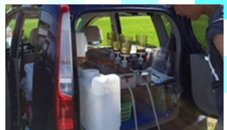
農業排水路での環境DNAの採集・濾過作業
