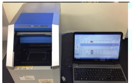
環境DNAを測定する定量PCR機器
