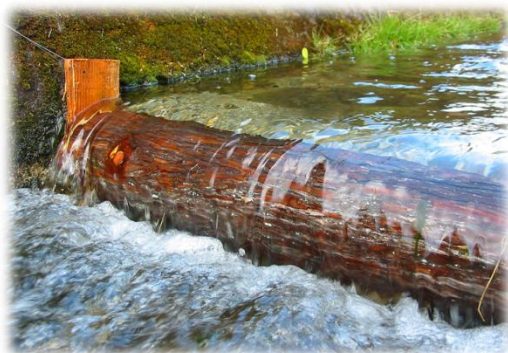
水路の底面に設置した間伐材 （下呂支所の実験水路にて）
