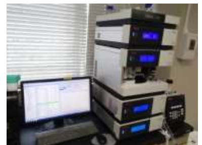
液体クロマトグラフィーによるATP関連物質の分析
