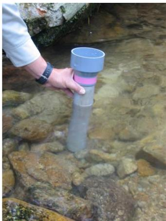
③ 塩ビ管を掘削場所の中央に立てる。
